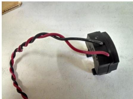
Passo V: O fio é colado com silver tape junto ao motor, não ficando expostos e evitando uma nova quebra.
