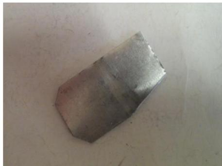
Escovas soltas, para manutenção, e que serão posteriormente montadas de acordo com os passos seguintes. A imagem mostra uma escova “condenada”, visto que o tamanho ideal para as mesmas, seria em torno de 3.5mm a 5mm.
