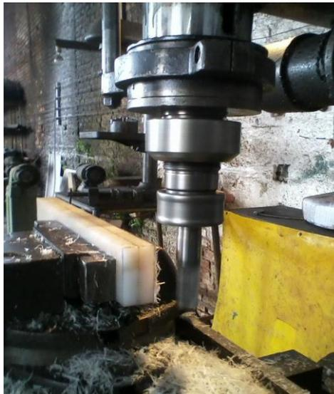
**Figura 6 - Usinagem das peças da estrutura principal**
