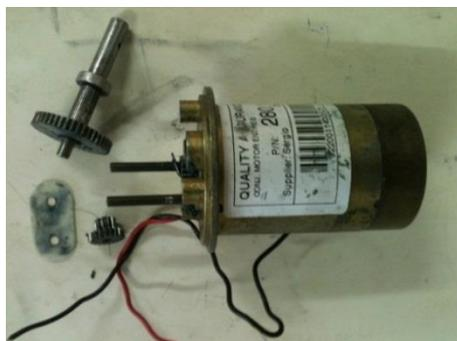
Limpar o eixo e a engrenagem com gasolina e com o auxílio de um pincel remova a graxa e a sujeira presente nas peças.
