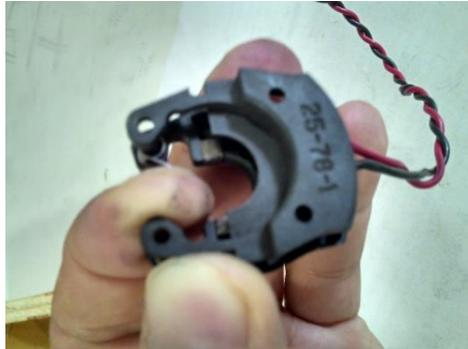
Passo II: Travar a mola das escovas com a ferramenta fabricada.
