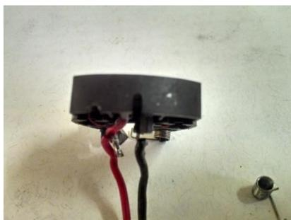
Passo III: O fio quebrado é novamente soldado, e encaixado no novo orifício.
