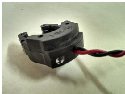
Passo II: Abertura de um novo orifício lateral ao já existente, para a passagem do fio.
