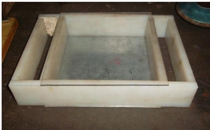
Figura 2 - Estrutura de nylon após ser fresada e tampo de nylon
