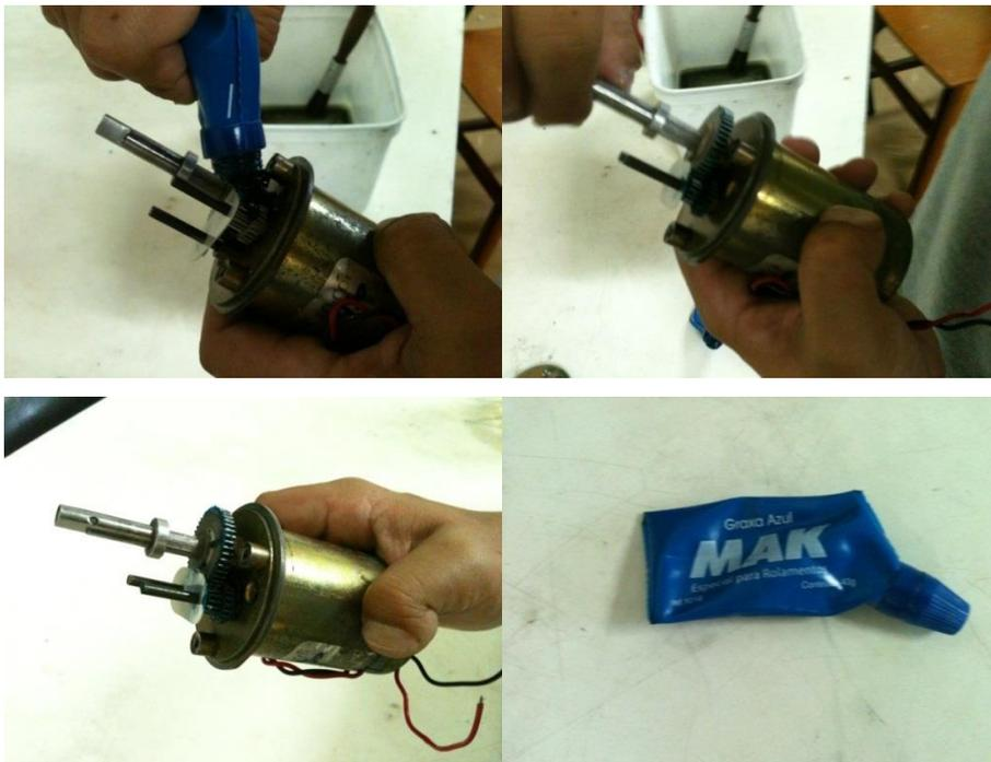
Durante a batalha o colar do eixo pode sair do lugar devido aos esforços axiais no eixo. Isso impede o bom funcionamento do motor. Durante a limpeza
