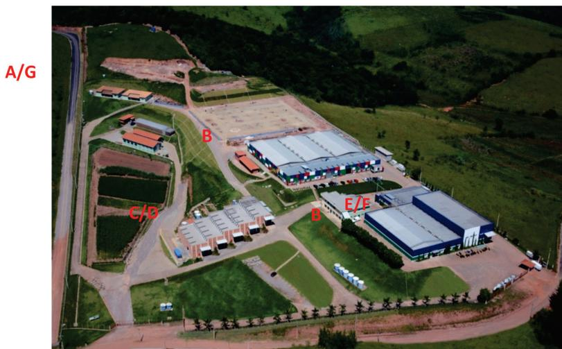
**FIGURA 9.** Vista aérea da planta industrial de produtos a base de fungos. (A) manutenção e multiplicação da matriz, (B) produção - massal em arroz, (C) beneficiamento – retirada dos conídios, (D) formulação, (E) lote - embalagem, (F) transporte – comercialização e (G) controle de qualidade.
